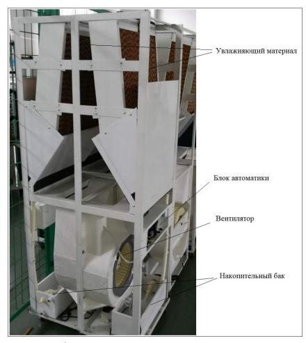
\*Один из вариантов компоновки увлажнителя
